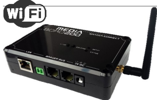
Модуль Интернет-управления котлом
